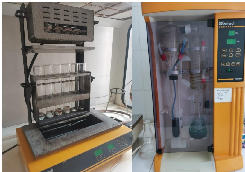
Figura 5.5 – Mineralizarea și distilarea probelor de grâu în vederea determinării conținutului de proteină
