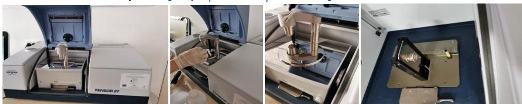
Figura 2.18. Spectrometru Bruker Tensor 27 FTIR, cuplat cu dispozitiv ATR cu cristal de diamant [Căpriță, F.C., ș.a., 2022]
