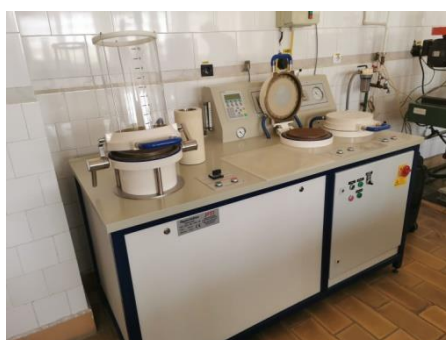
Figura 2.14. Formatorul Rapid Köthen (sursa: Căpriță, F.C., Laboratorul de Preparare Paste Fibroase –Cephohart SA Brăila)
