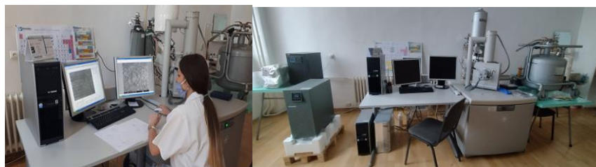
Figura 2.17. Microscopul electronic de baleiaj (SEM) (sursa: Căpriță, F.C., Laboratorul de Microscopie electronică din cadrul Facultății de Științe și Mediu – UDJG)
