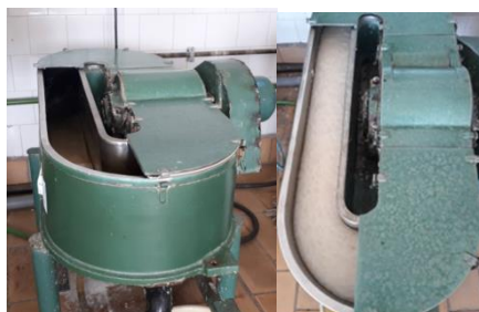
Figura 2.9. Holendru de măcinare a celulozelor la nivel laborator, Valley (sursa: Căpriță, F.C., Laboratorul de Preparare paste fibroase –Cephohart SA Brăila)
