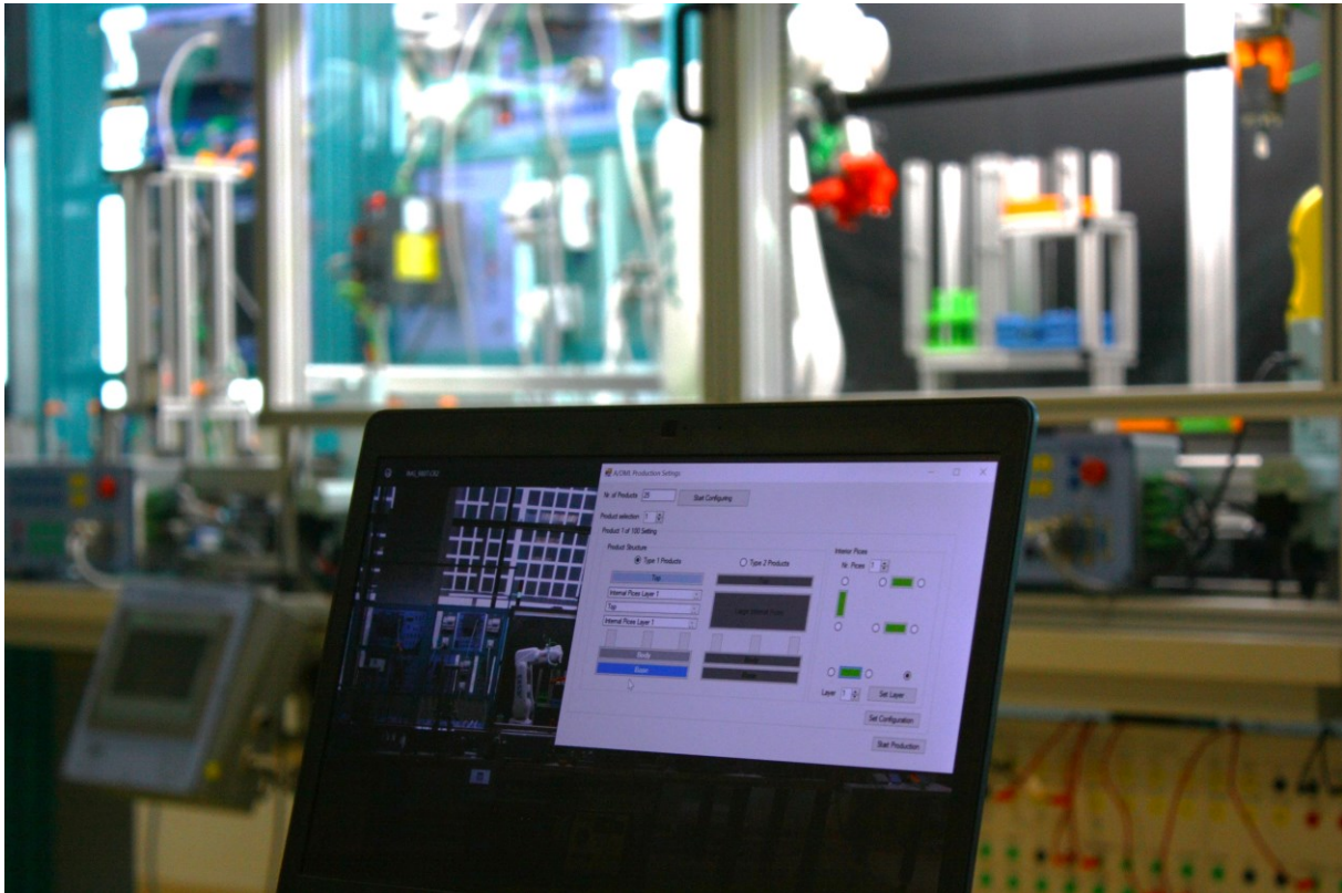
Figura 62. Aplicație Client-Server conectată cu sistemul integrat pentru fabricația flexibilă
