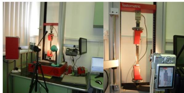
Fig. 2.9. Mașina de testare mecanică universală Testometric 5k M350 din cadrul Laboratorului de Cercetare ale Materialelor Polimerice
