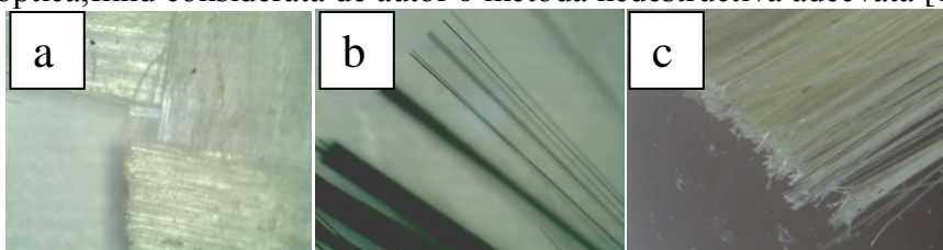
Fig. 2.1 Fibrele utilizate: a. fibre de sticlă; b. fibre de carbon; c. fibre aramidice
