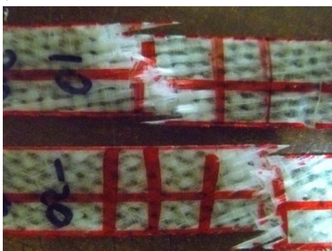
Fig. 5.6. Procesul de cedare a laminatului format cu două straturi de țesătură, pentru compozitele 10_30, -20_20.
