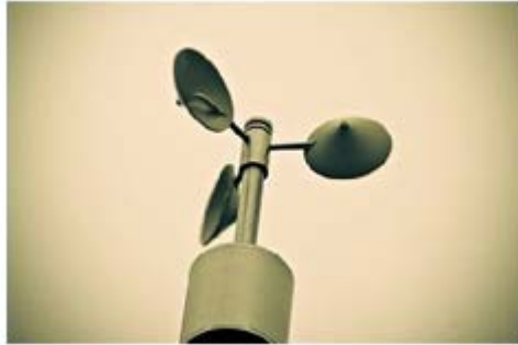
a) Fig. 2.2 Instrumente de măsurare a condițiilor de vânt: a) Anemometru și b) aero- morișca
