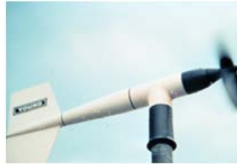
a) Fig. 2.2 Instrumente de măsurare a condițiilor de vânt: a) Anemometru și b) aero- morișca
