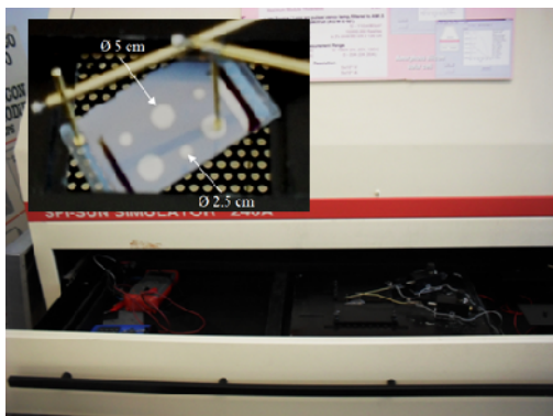
Fig. 2.13. Simulatorul solar și detaliu probă.
