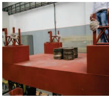
Fig. 3.25 Încărcarea structurii platformei
