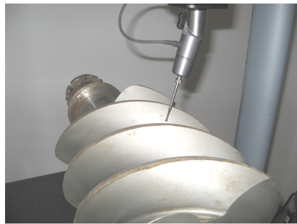
Fig. 67. Măsurarea profilului axial al rotorului conducător
