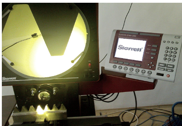
Fig. 53 Aparatul de măsurat, profil proiector Scarrett
