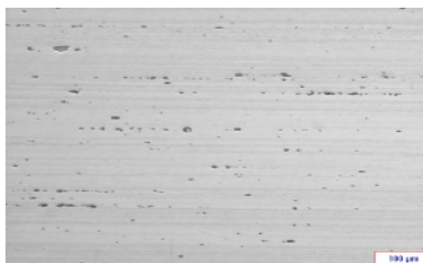
Fig.5.8. TTMI3 +TTMF neconventional; Atac 0,5% HF
