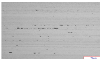
Fig.5.8. TTMI3 +TTMF neconventional; Atac 0,5% HF
