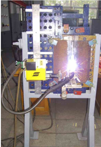
Fig. 6.5. Sudarea mecanizată MAG pe suport ceramic plat a probelor cap la cap în poziția PF.
