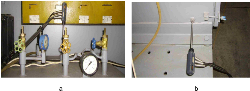
Fig. 7.1. Instalația pentru determinarea noxelor și a emisiilor sonore la sudarea mecanizată
