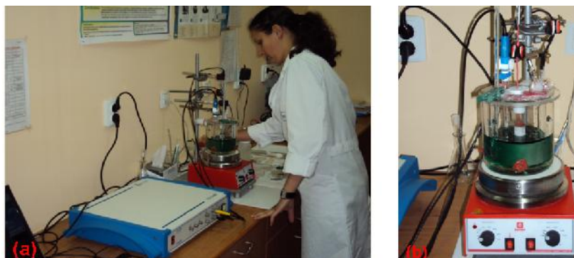
Fig. 2.6. Set-up-ul utilizat la cinetica electro-co-depunerii: (a) poten iostat VoltaLab PGZ100 conectat la un calculator; (b) celula electrolitic
