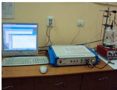
Fig. 2.13. Set-up utilizat la comportarea la coroziune cu poten iostatul VoltaLab PGZ100 conectat la un calculator
