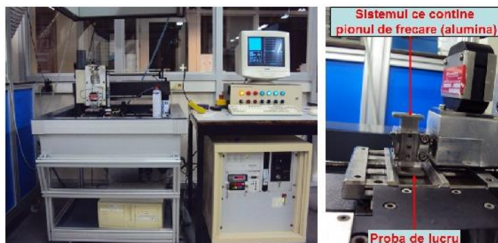
Fig. 2.14. Set-up-ul utilizat la realizarea testelor de uzur prin frecare
