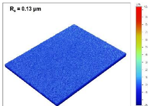
Fig. 8.1. Microtopografia suprafeței electrozilor cu strat de nichel pur
