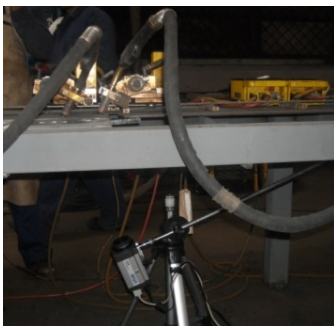
Fig. 8.18. Poziționarea termocamerei în cazul sudării MIG și distanța dintre capetele de sudare
