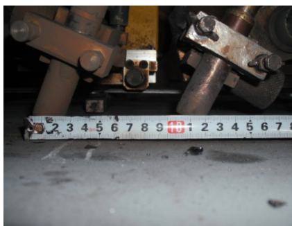
Fig. 8.18. Poziționarea termocamerei în cazul sudării MIG și distanța dintre capetele de sudare
