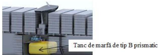
Fig.2-5 Tanc de marfă independent tip B sub formă prismatică, sursă internet 19
