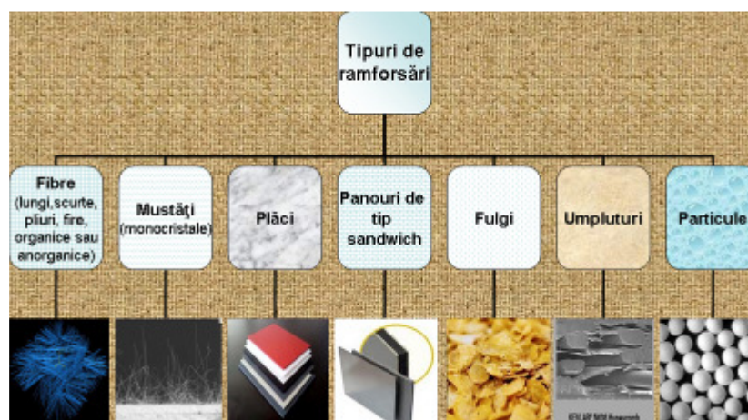
Fig. 1.3. Tipuri de ramforsări folosite la proiectarea materialelor compozite
