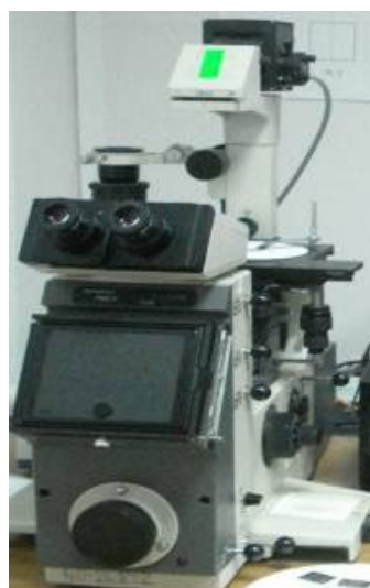
Fig. 2.8. Microscop optic Olympus și sistem computerizat de fotografiere (1000x)
