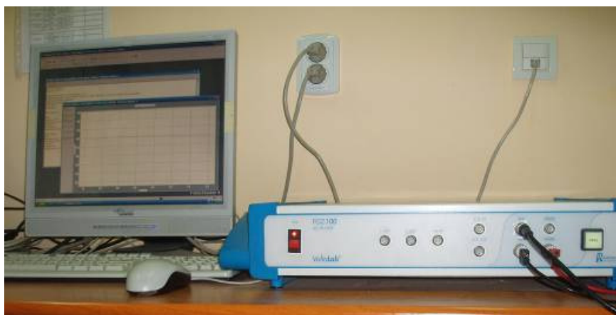
Fig. 2.11. Set-up utilizat la comportarea la coroziune compus din potențostatul VoltaLab PGZ100 conectat la un calculator
