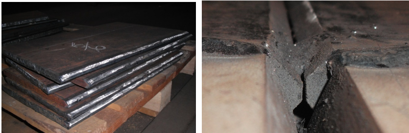
Fig. 8.11. Probele din oțelul X70 utilizate la sudarea cu două arce
