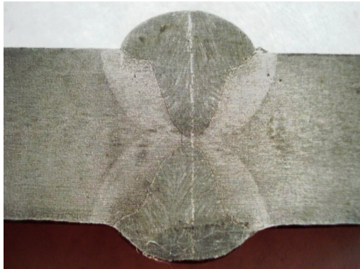
Fig. 8.19. Macrostructura îmbinării sudate cu două arce pentru grosimea de s = 19,1\text{mm}
