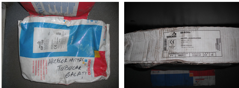
Fig. 8.10. Cuplu sârma flux pentru sudarea cu două arce
