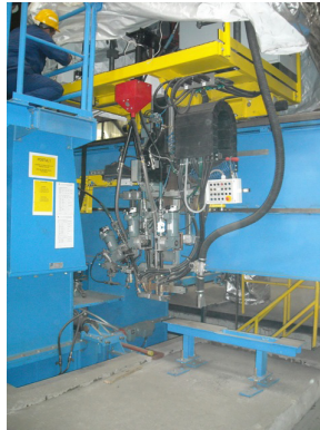
Fig. 8.5. Vedere de ansamblu al căruciorului cu capete de sudare
