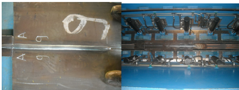
Fig. 8.13. Îmbinarea sudată și realizarea acesteia pentru proba P9A
