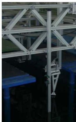
Fig.4.11 Sonda de val, tractorul de deplasări pe verticală și unghi de tangaj, sistemul de achiziție date și controlul căruciorului, modelul ITTC instrumentat pentru probe
