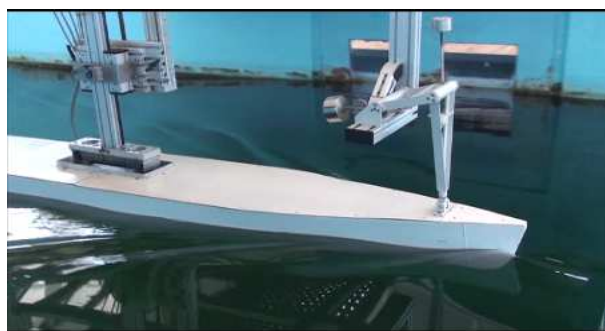
Fig.4.13 Oscilații în plan vertical, modelul experimental ITTC u_s=1\text{m/s} , val de întâlnire f_c=1,004\text{Hz}
