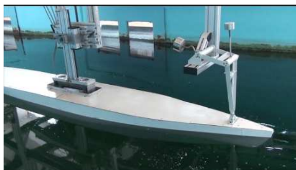
Fig.4.12 Oscilații în plan vertical, modelul experimental ITTC u_s=0\text{m/s} , val de întâlnire f=0,695\text{Hz}
