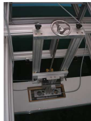
Fig.4.11 Sonda de val, tractorul de deplasări pe verticală și unghi de tangaj, sistemul de achiziție date și controlul căruciorului, modelul ITTC instrumentat pentru probe
