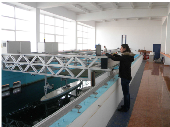
Fig.4.10 Căruciorul automatizat pentru tractarea modelelor la Bazinul de carene
