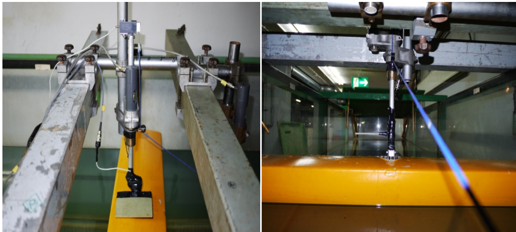
Figura 5.4 Prezentare model și setări experimentale - corp mobil
