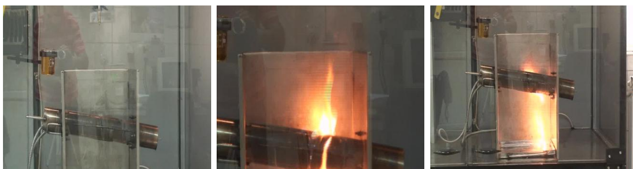
Fig. 4.7. Ulei de soia, testat la temperatura suprafeței tubului de 510°C, “I(D)”
