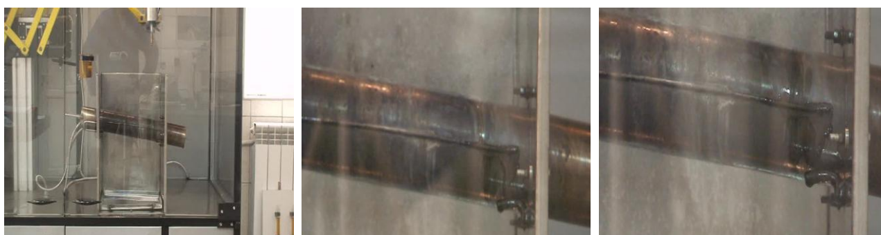
Fig. 4.6. Ulei de soia, testat la temperatura suprafeței tubului de 500°C, “N”
