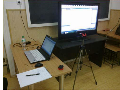
Fig.4.9 Sistem cu senzor Kinect pentru determinarea abaterii posturale
