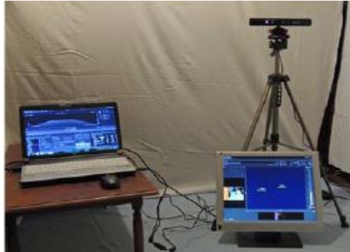
Fig.4.7 Sistemul de analiză a cinematicii cu senzor Kinect [Ganea D.,2013]
