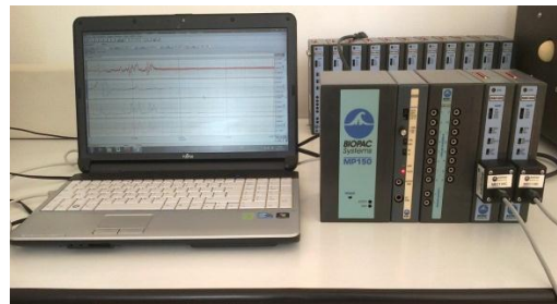
Fig.6.1 Sistem de analiză EMG
