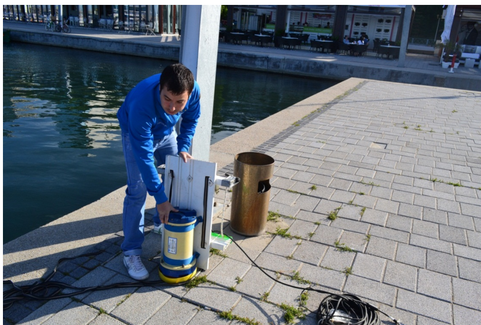
Figura 6.2 ADCP-ul a fost montat pe o placă de plastic de aproximativ 1cm grosime, fixarea acestuia realizându-se cu șuruburi. Placa a fost mai apoi amplasată în zona din spate (în dreapta) a ambarcațiunii cu două frânhii trecute pe sub șalupă și fixate în chingi.
