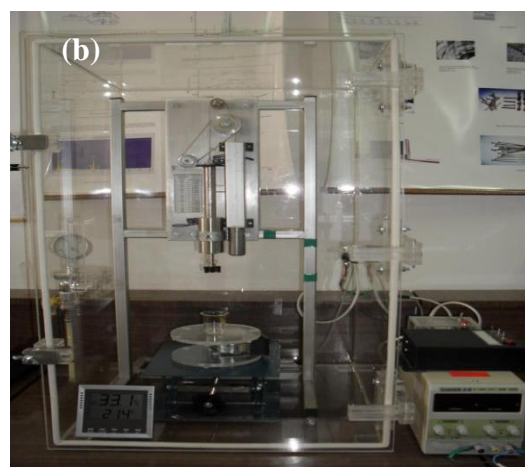
Fig. 2.9. Instalatii de depunere a filmelor sol-gel, tehnica spin-coating (a) și tehnica dip-coating (b) CNMF-UDJG
