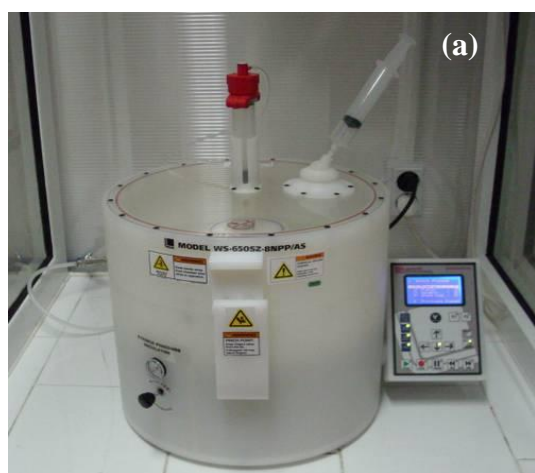
Fig. 2.9. Instalatii de depunere a filmelor sol-gel, tehnica spin-coating (a) și tehnica dip-coating (b) CNMF-UDJG
