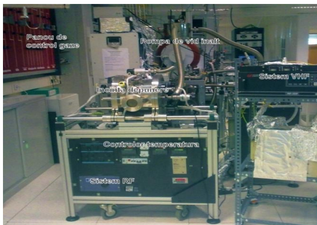
Fig. 2.2. Imagine de ansamblu a instalatiei PECVD utilizata (CEMOP-FCT-UNL)
