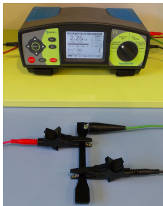
Figura 3.8. Măsurarea rezistenței electrice de izolație a probelor
