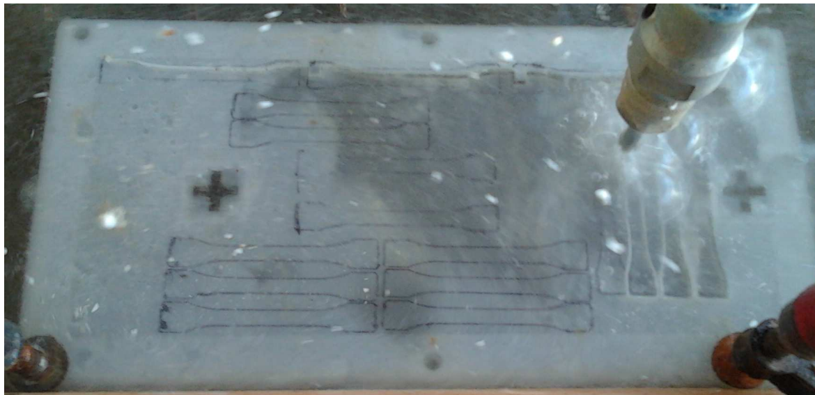
Figura 3.3. Operația de tăiere cu jet de apă și nisip pentru prelevarea epruvetelor de tip IBA
