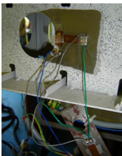
Figura 2.13 Amplasarea traductoarelor tensometrice
