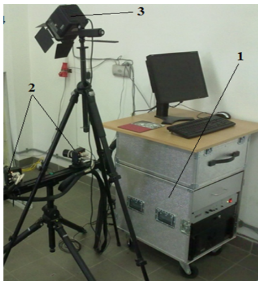
Figura 2.14 Componentele sistemului optic de măsurare Aramis HS
