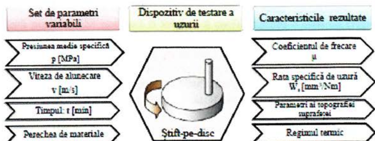
Fig. 3.4. Datele de intrare și de ieșire în cazul testului știft-pe-disc
