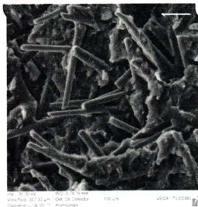
Fig. 4.8. Imagine SEM suprafața uzată a discului de PPS + 40% fibre de sticlă
