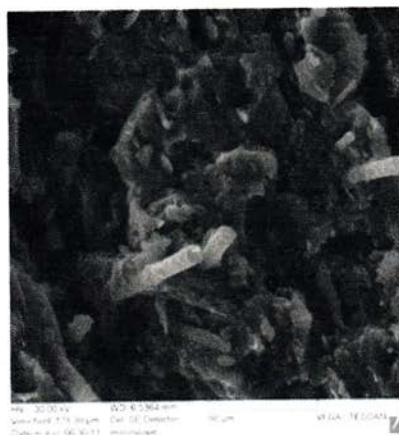
Fig. 4.21. Imaginea SEM a zonei uzate de pe discul PPS PVX ( p = 0,75 MPa, v = 0,75 m/s) la scara 50 \mu\text{m}
