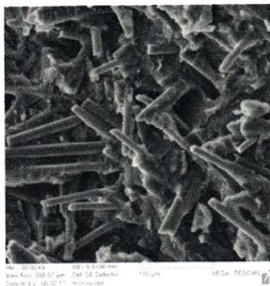
Fig. 3.14. Imaginea SEM a suprafeței discului uzat din PPS +40 % fibre de sticlă ( v = 0,75\text{ m/s} , p = 0,75\text{MPa} )
