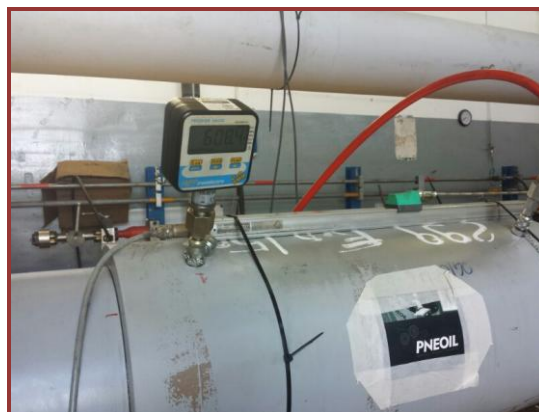
Fig. 5.2. Încercare de presiune pentru un FVD 500 ±100
