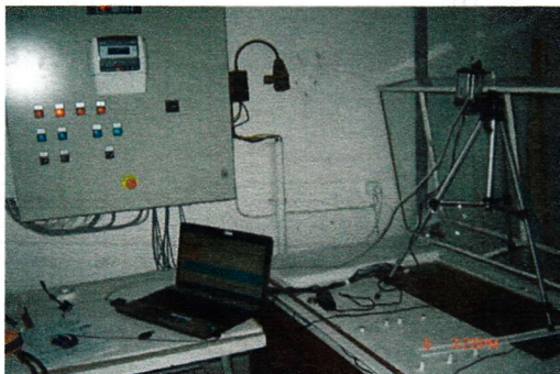
Fig.6.11 Utilizarea camerei de termografiere pentru măsurarea temperaturii pe suprafața pistei
