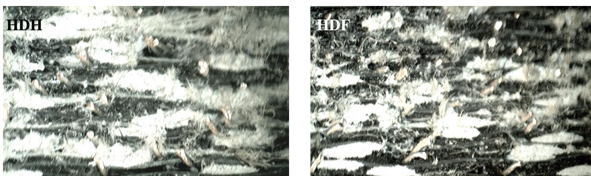
Fig. 3.6. Imaginile microscopice ale suprafețelor transversale ale materialelor armate cu țesătură hibridă.
