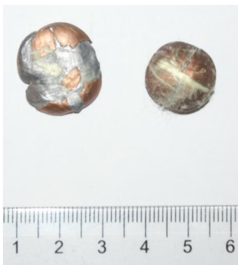
Fig. 3.8. Gloanțe extrase din pachete rigide: stânga - din pachetul realizat cu LFT SB1plus, dreapta - din pachetul realizat din LFT SB1
