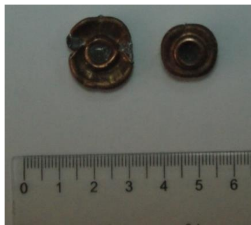
Fig. 5.12. Vedere din spate a gloanțelor extrase din pachete rigide (stânga – glonț extras din LFT SB1, dreapta – glonț extras din CT 709)
