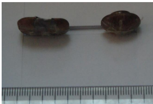
Fig. 5.11. Vedere laterală a gloanțelor extrase din pachete rigide (stânga – glonț extras din LFT SB1, dreapta – glonț extras din CT 709)
