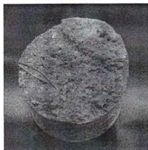
Fig. 8.12 Aspectul cuponului de vopsea acrilică extras de pe suprafața de beton
