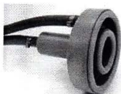
Fig. 5.5 Celulă cu două camere pentru crearea vidului
