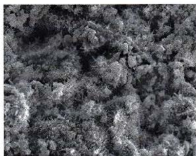
Fig. 7.38 Micrografie SEM a probei de beton cu fibre și aditiv acrilic, la vârsta de 28 zile, mărire: a) \times 2000 și b) \times 2500
