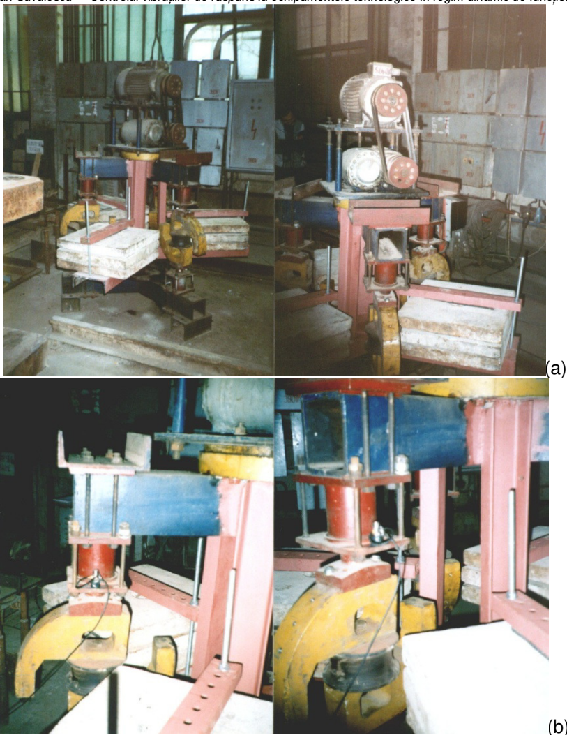
Fig. 5.4.b Standul vibrator unidirecțional – imagini din timpul testelor experimentale. (a) imagini de ansamblu; (b) detalii bacuri de prindere și poziționare [13, 104,105]
