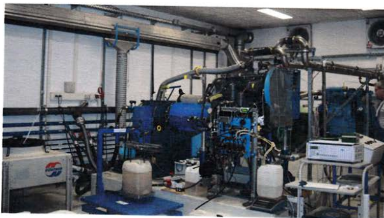
Fig. 4.22. Motorul TCD2012 și sistemul de emulsie atașat acestuia.
