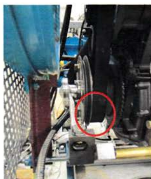
Fig. 4.27. Traductorul pentru turația și unghiul arborelui cotit.
