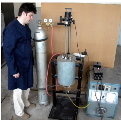
Figura 5.23. Instalație pentru determinarea vâscozității dinamice aparente
