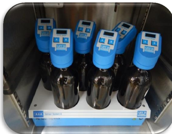
Fig. 2.26. Analizor BOD5 marca VELP IP54 (foto original)
