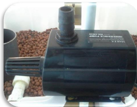
Fig. 2.11. Pompă submersibilă tip HAILEA HX 6830 folosită pentru alimentarea unităților acvaponice. (foto. original)
