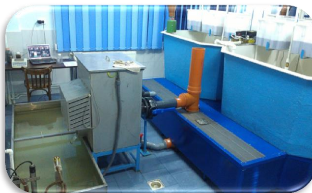
Fig. 2.9. Unitatea de îndepărtare a solidelor grosiere și unitatea de decantare. (foto. original)
