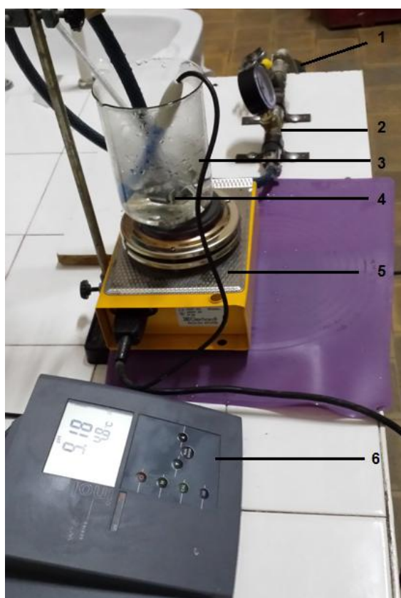
Fig. 8.8. Instalația experimentală cu generator sonic mecanic, în timpul tratamentului apelor amoniacale cu încălzire
