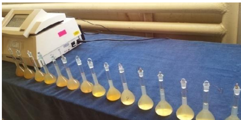
Fig.5.2. Baloane cotate cu probe de apă tratată sonic/ultrasonic, în timpul determinării conținutului de amoniac la spectrofotometru
