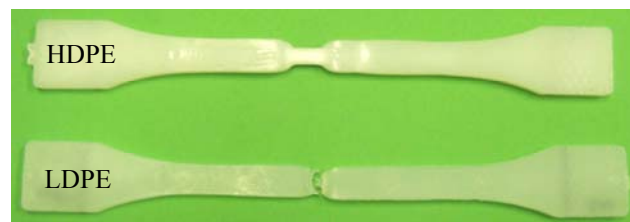
Figura 5.2. Epruvete monocomponent după testarea la tracțiune[41]
