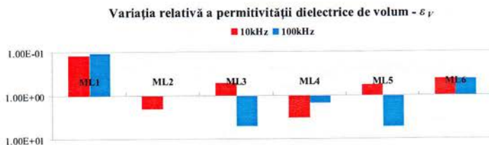
Fig. 6.37. Variația relativă a permitivității dielectrice – pseudo-laminate cu matrice epoxidică.
