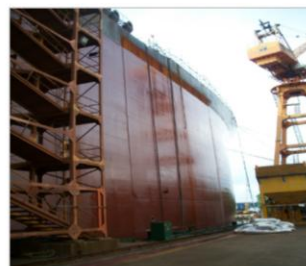
Fig.1.40 Protecția la impact a bordajului cu sistemul SPS (IE, 2016)
