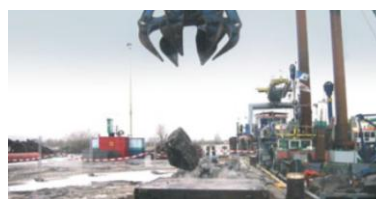
Fig.1.39 Testare la impact cu o rocă (IE, 2016)
