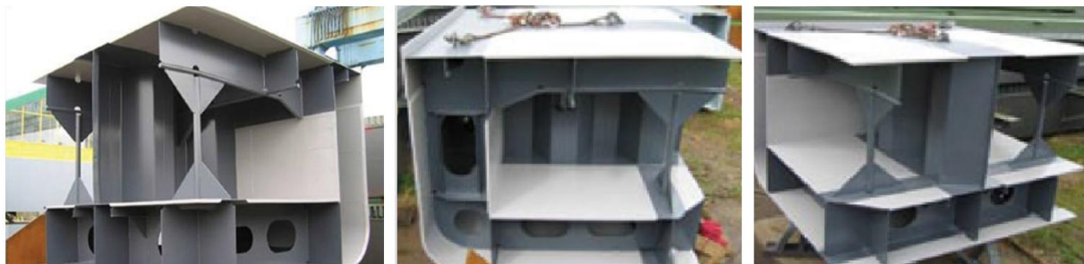
Fig.1.41 Macheta unei nave cisternă Type C cu structura SPS (IE, 2016)
