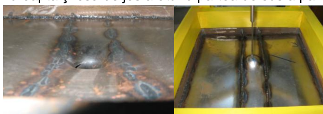
Fig.5.25 – Deformată remanentă – model 2
