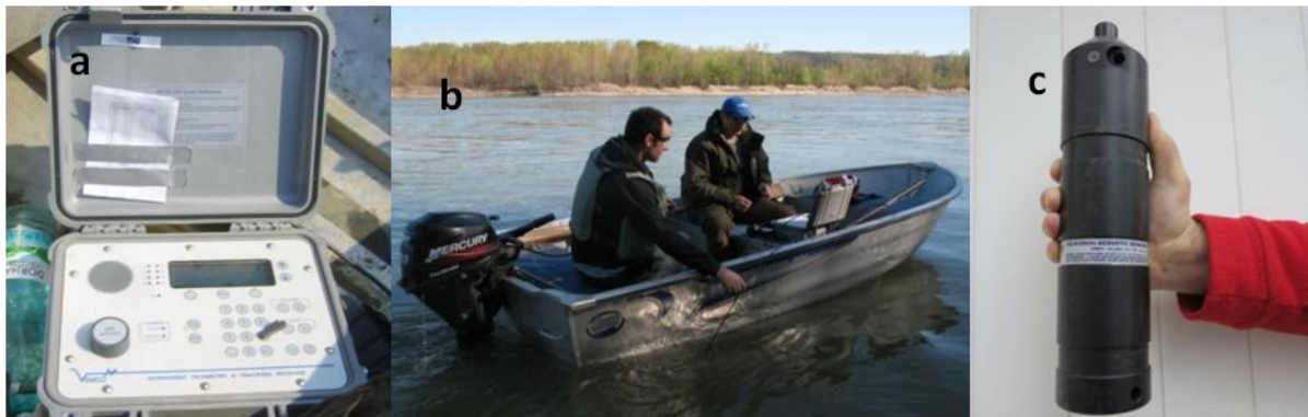
Figura 2 (a) Receptor acustic VR 100, (b) urmărirea activă a sturionilor din Dunăre cu ajutorul receptorului acustic VR100, (c) receptor acustic VR2W
