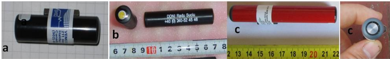
Figura 1. (a) Marcă Vemco V13TP; (b) marcă Thelma 16 mm, (c) marcă Vemco și senzor V16TP
