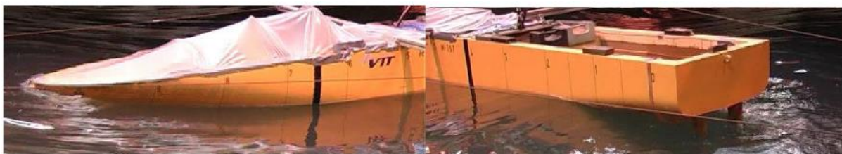
Fig. 2.3.7 – Modelul Seatech-D în timpul probelor [68]
