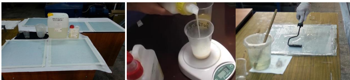
Figura 5.7 a) Pregătirea sticlei-suport pentru turnarea rășinii epoxidice, b) Cântărirea soluțiilor și împrăștierea rășinii epoxidice, c) Turnarea
