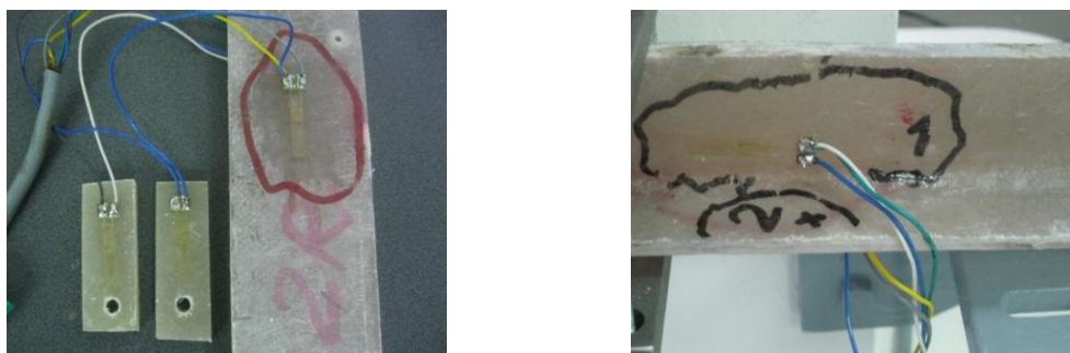
Figura 4.38 Stabilirea și lipirea mărcilor tensometrice
