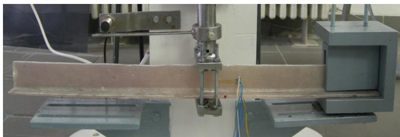
Figura 4.37 Modul de prindere a epruvetei
