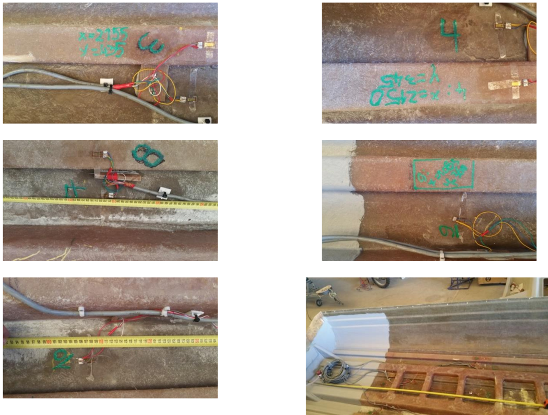
Figura 3.6. Detalii privind pozițiile de amplasare ale mărcilor tensometrice
