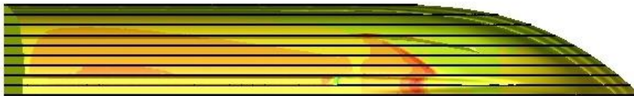
Figura 4.5. Divizarea carenei în segmente transversale de 100 mm lățime
