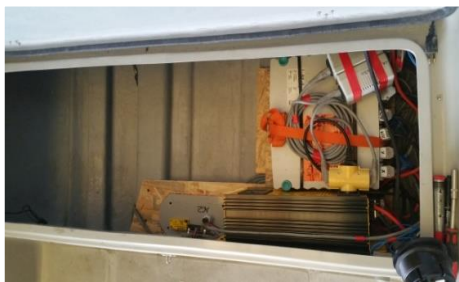
Figura 3.5. Sursa de alimentare și dispunerea aparaturii de măsurare în santina ambarcațiunii
