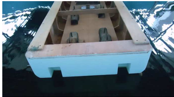
Figura 3.13.b. Imagine cadru înregistrată la proba v=0 m/s, T8 , \mu=90^\circ , vedere din pupa
