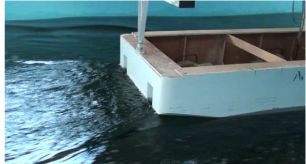
Figura 3.10.b. Imagine cadru înregistrată la proba v=1,28 m/s, T4 , \mu=180^\circ , vedere din pupa
