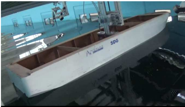
Figura 3.13.a. Imagine cadru înregistrată la proba v=0 m/s, T8 , \mu=90^\circ , vedere din tribord
