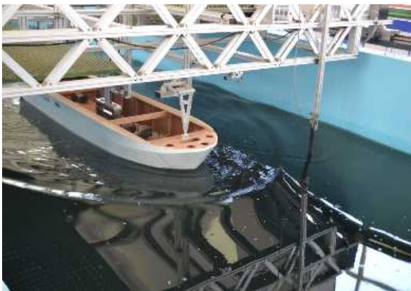
Figura 3.7. Modelul experimental dispus longitudinal bazinului de carene
