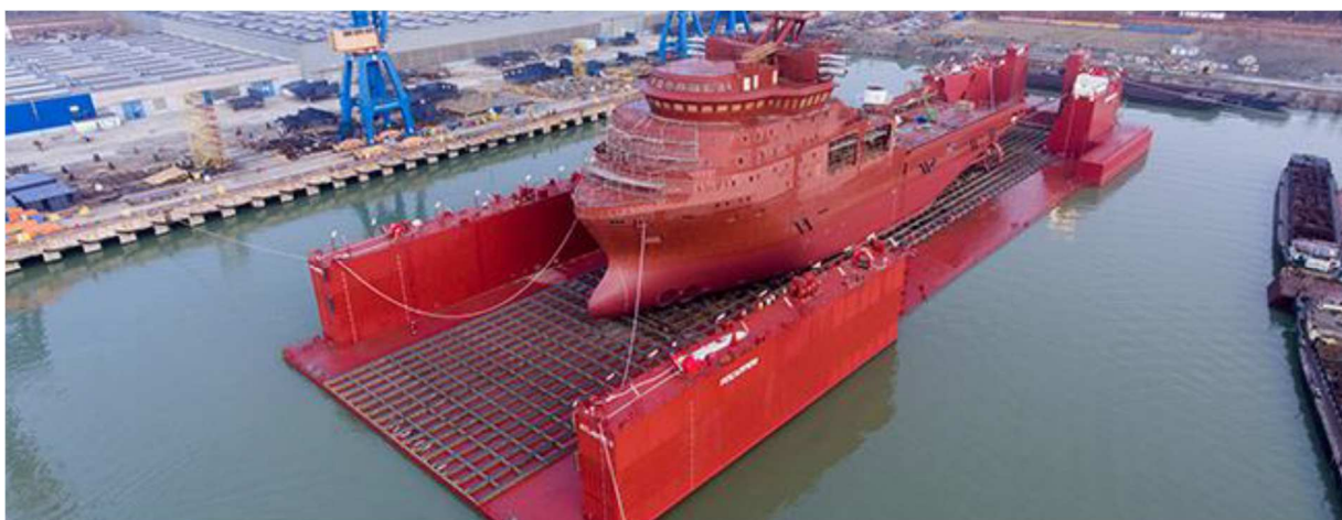
Figura. 1.3. Docul plutitor Dock_VARD_Tulcea la finalul andocării totale a cazului de calcul din capitolul 7.2.2. [12]
