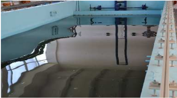
Figura 3.5. Generatorul de valuri de la bazinul de carene
