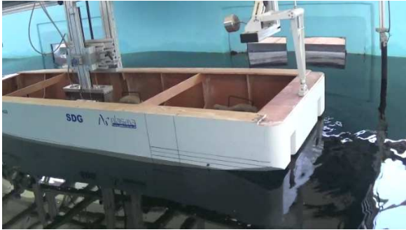
Figura 3.12.a. Imagine cadru înregistrată la proba v=0 m/s, T_6 , \mu=0^\circ , vedere din pupa
