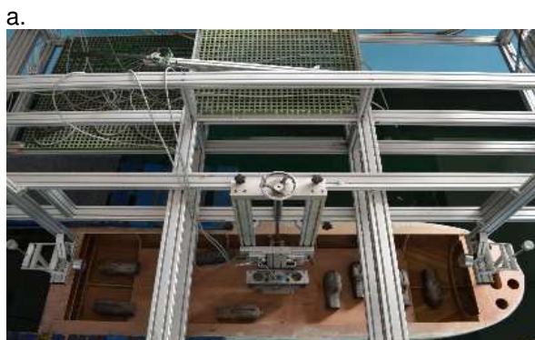
Figura 3.4.a, b. Traductoarele pentru măsurarea deplasărilor la oscilațiile verticale, a unghiului la oscilațiile de tangaj și ruluu
