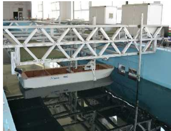
Figura 3.8. Modelul experimental dispus transversal bazinului de carene
