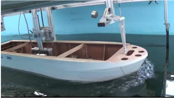
Figura 3.10.a. Imagine cadru înregistrată la proba v=1,28 m/s, T4 , \mu=180^\circ , vedere din prova
