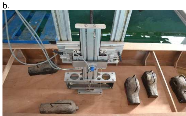
Figura 3.4.a, b. Traductoarele pentru măsurarea deplasărilor la oscilațiile verticale, a unghiului la oscilațiile de tangaj și ruluu
