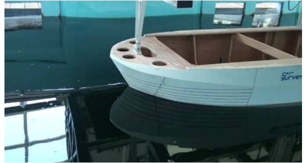
Figura 3.12.b. Imagine cadru înregistrată la proba v=0 m/s, T_6 , \mu=0^\circ , vedere din prova
