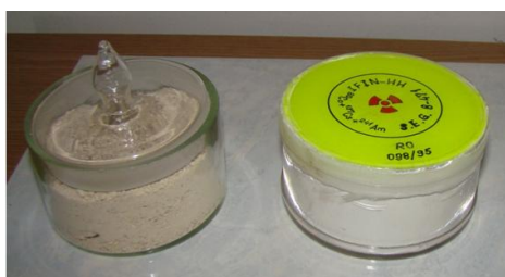
Figura 2.12 - Sursa radioactivă utilizată pentru calibrarea gamaspectrometrului și proba de măsurat – geometrie identică
