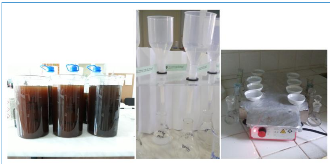
Figura 2.3 - Concentrarea ^{210}\text{Po} , ^{210}\text{Pb} prin coprecipitare, separarea pe coloane cu rășină SR și purificare eluaturi ^{210}\text{Po} , ^{210}\text{Pb}
