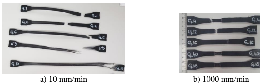
Fig. 4.16. Epruvete rupte la tracțiune, la viteze diferite de încercare pentru materialul G
