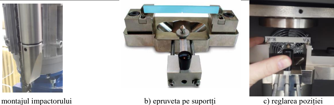
Fig. 5.2. Mașina de testare Charpy, INSTRON CEAST 9340
