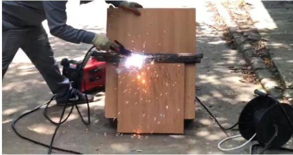
c) Descărcarea Corona simulată prin arc electric - sudură (Set date 3)
