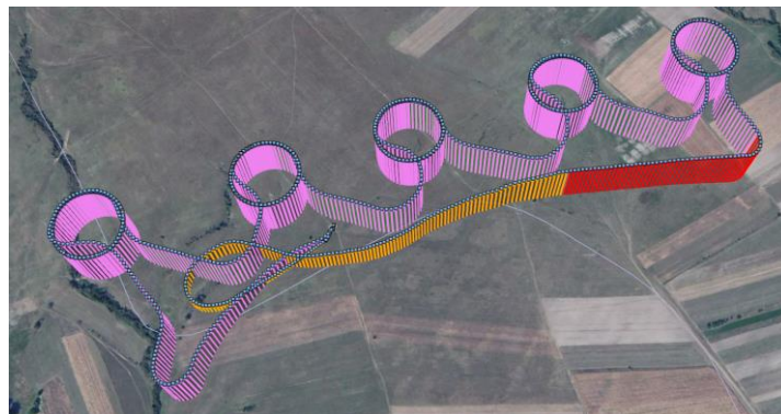
Fig. 4.10. Ruta de zbor executată de sistemul UAV proiectat
