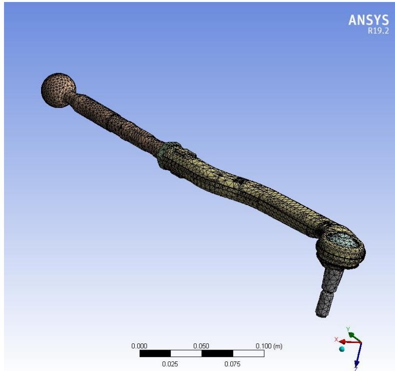
Figura 4. 3 Discretizarea sistemului cu elemente de solid
