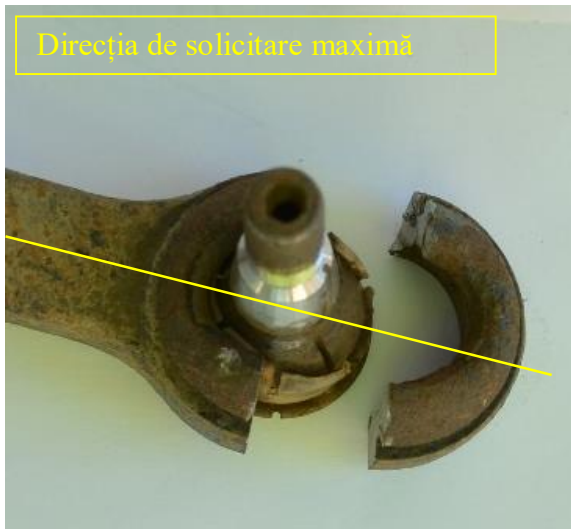
Figura 4. 5 Cap bară secționat transversal
