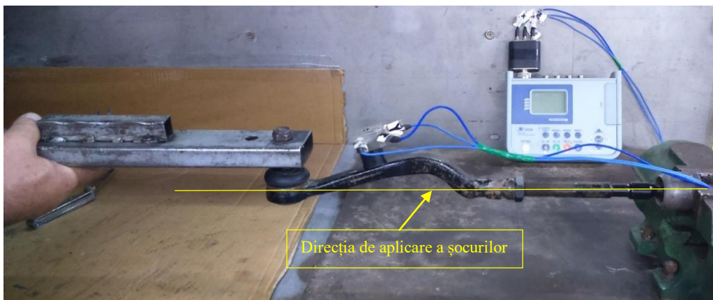
Figura 5. 1 Poziționarea dispozitivelor la testele pe banc
