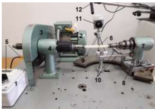
Figura 2. 3. Stand de testare la oboseală.
