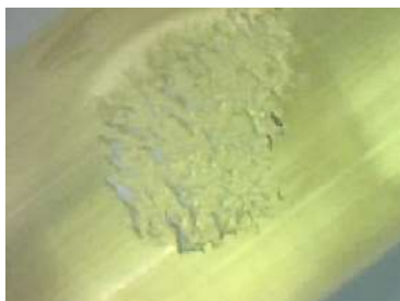
Figura 3. 9. Uzura apărută pe contrapiesă.
