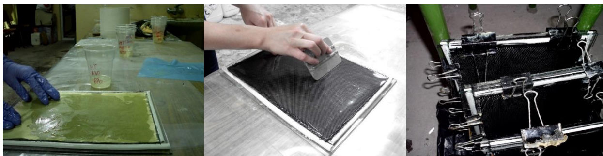
Fig. 2 Formarea pseudo-laminatelor prin metoda hand lay-up (de la stânga la dreapta: stratificare; evacuare gaze; polimerizare în matriță)
