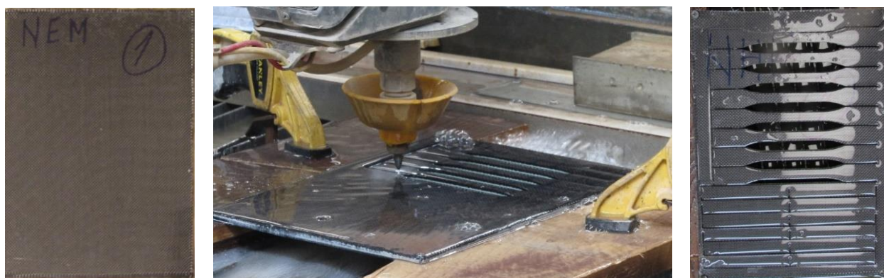
Fig. 3 Etapele de extragere ale epruvetelor, utilizând mașina de tăiat cu jet de apă (de la stânga la dreapta: pseudo-laminat extras din matriță; debitarea pseudo-laminatului; epruvetele înainte de extragerea din pseudo-laminat)
