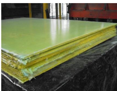
b) componenta din compozit a blindajului
