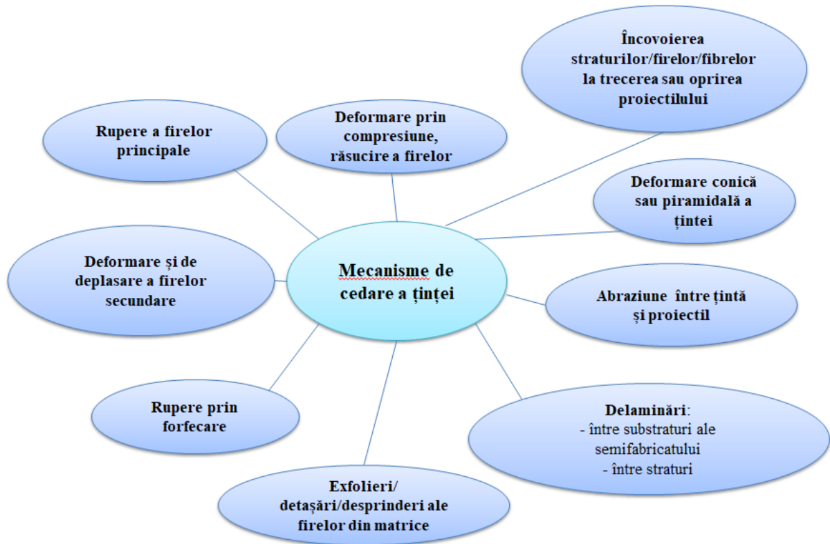
Fig. 5.11. Mecanisme de cedare, caracteristice țintei
