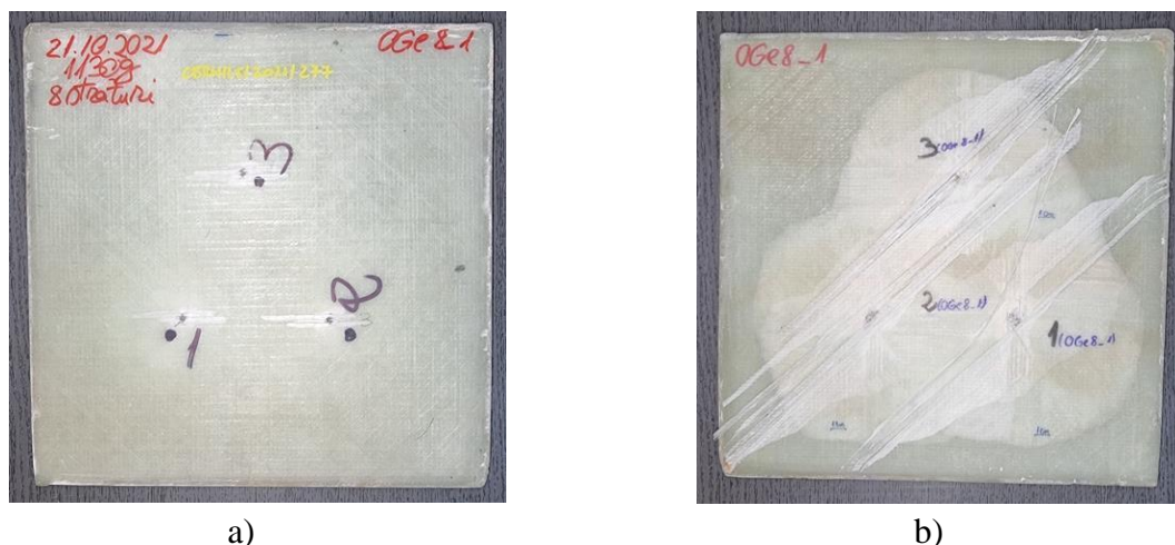
Fig. 5.5. Rezultatele tragerii pe placa cu 8 straturi cuadriaxiale de fibră de sticlă: a) față, b) spate
