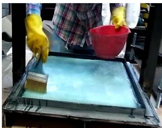
Fig. 4.8. Impregnarea straturilor cu amestecul de rășină și întăritor
