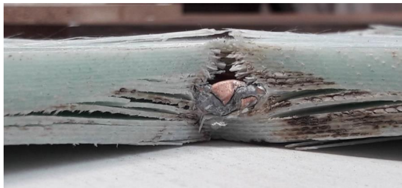
Fig. 1.6. Compozit cu fibră de sticlă și rășină, de grosime 13 mm, după impact cu proiectilul de 9 mm FMJ, la viteza de 420 m/s [22]
